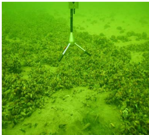
Figuur 12a: Een turbulentiemeter vlak boven een mosselbank
