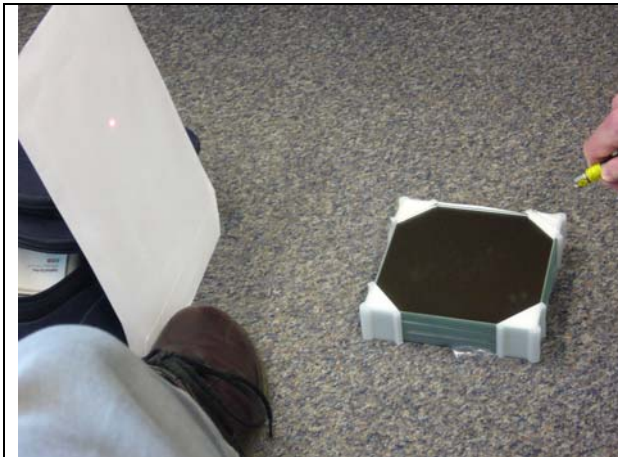
Figuur 3a Spiegelreflectie: De laser pointer is gericht naar de spiegel. Maar vanaf opzij zien we geen lichtvlek op de spiegel. Al het laserlicht wordt slechts in één richting gereflecteerd, naar het papieren scherm links. Op het papier zien we een lichtvlek. Het papier reflecteert het licht diffuus (niet-spiegelend) naar alle kanten, inclusief in de richting van de camera.
