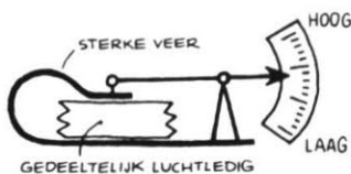
Het principe van de metaalbarometer
