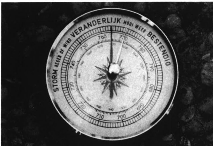
Metaalbarometer. Op de buitenste schaalverdeling lees je de luchtdruk af in centimeter kwik, op de binnenste schaalverdeling in millibar
