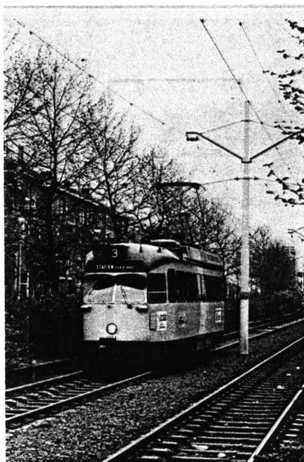
Een Haagse tram. De electromotor van de tram krijgt stroom van een draad boven de rails.
