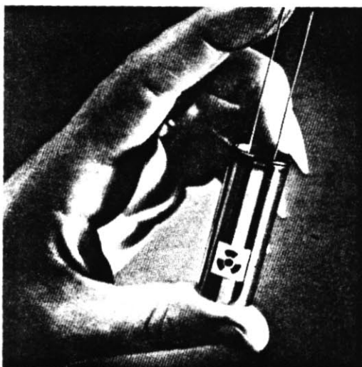
Een miniatuur batterij werkend op radio-actieve stoffen, in dit geval Plutonium. Het voorziet een hartpacemaker 10 jaar van energie. Dit is een positieve toepassing van de kennis van het atoom.
