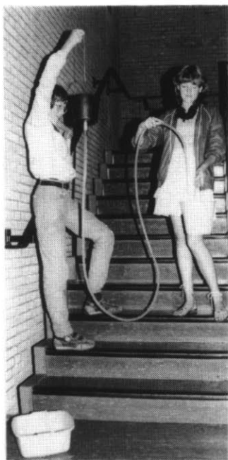
Een model van een slangemmerpomp. De installatie om de emmer omhoog te draaien is hier weggelaten
