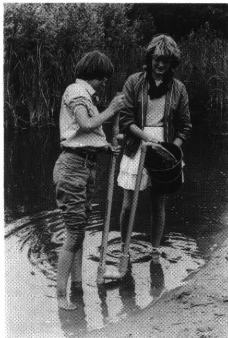
Een model van de perspomp van pvc-buis. In Tanzania voorkomt de pomp dat je in het water gaat staan (gevaar van infectie van bilharzia !)
