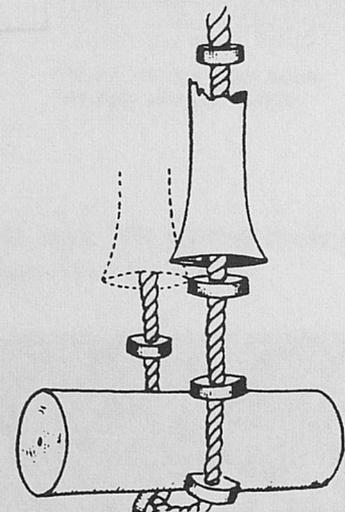
Recaliente el tubo de plástico en las terminales para darle el acabado de "embudo".
