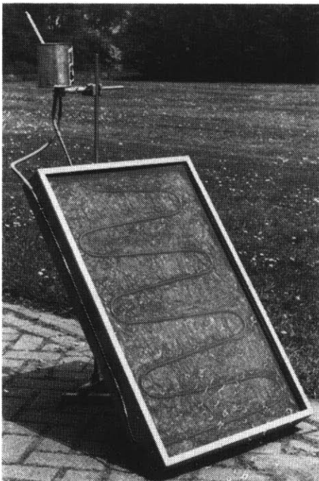
Opstelling zonnecollector. Het waterreservoir is geïsoleerd.
