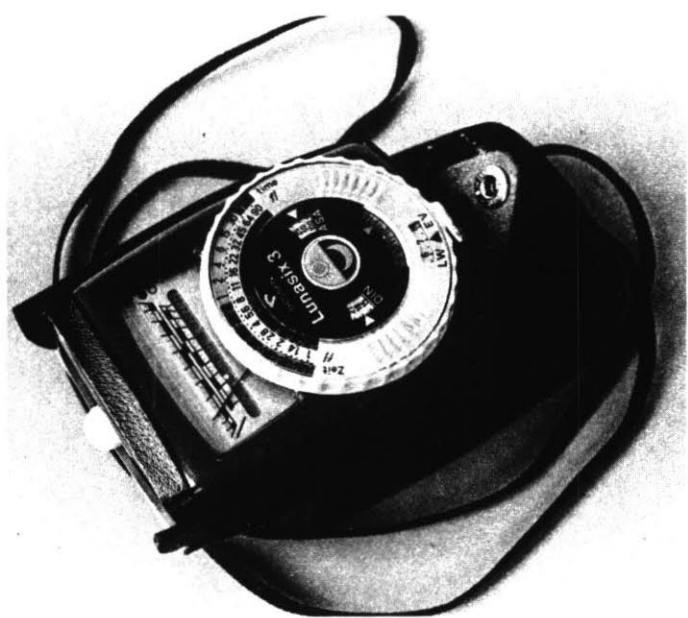
De belichtingsmeter geeft de lichtsterkte aan in tijden. Met de tabel kun je die tijden omzetten in lux.
