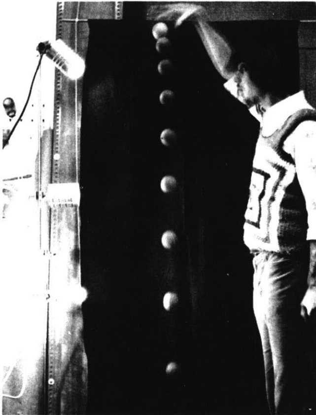
De snelheid van een vallend voorwerp bepalen met een stroboscopische foto
