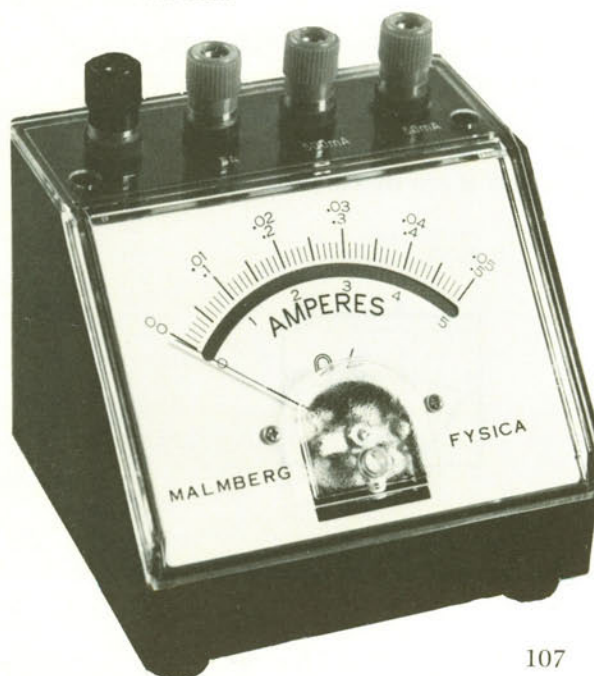
fig. 13 Een voorbeeld van een stroommeter met drie verschillende meetbereiken.
