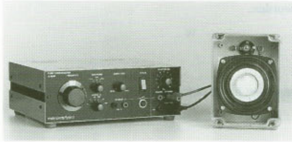
FIG. 17 Een luidspreker, aangesloten op een toongenerator.
