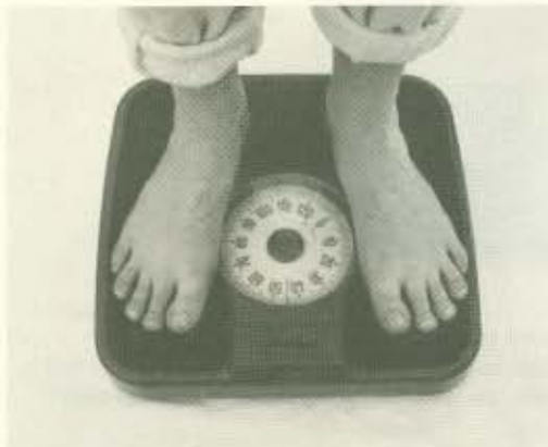
fig. 13 Eigenlijk wordt je gewicht (N) bepaald, maar de schaalverdeling is zo uitgevoerd dat je je massa (kg) kunt aflezen. Je moet natuurlijk wel stilstaan.
