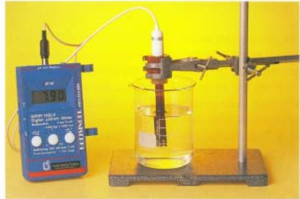
FIG. 36 Opstelling voor het bepalen van de pH .
