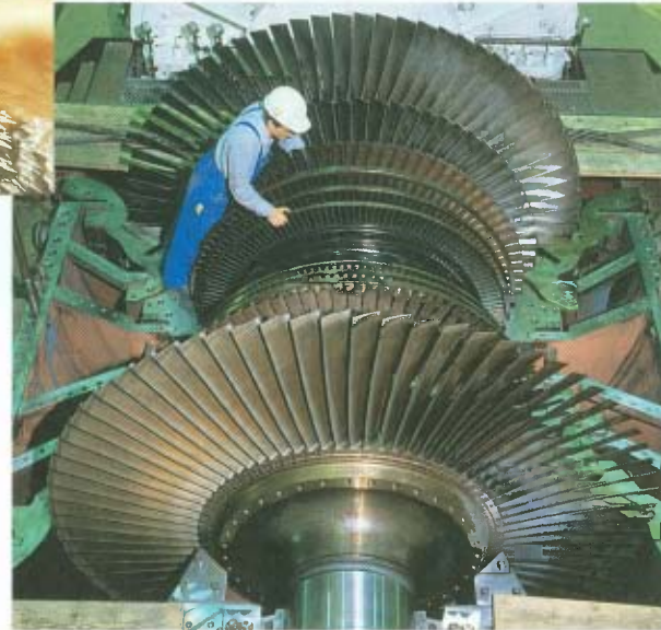
FIG. 3 De schoepen van een stoomturbine.
