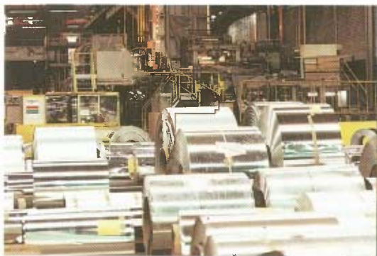
FIG. 27 Blik is dun gewalst staal met een heel dun laagje tin.
