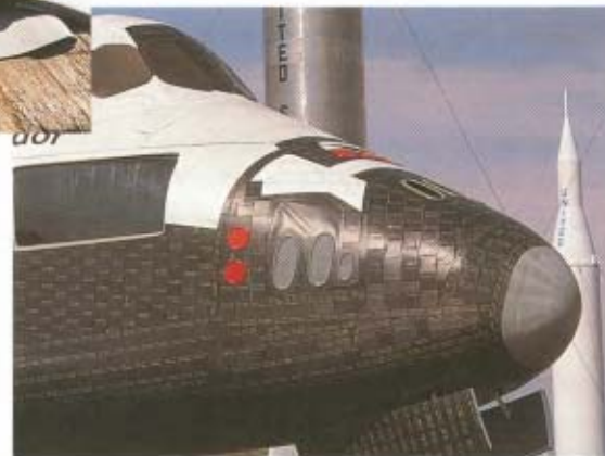
FIG. 17 Space shuttle met een keramische laag aan de onderkant.
