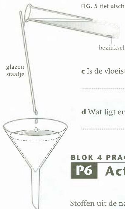
FIG. 5 Het afschenken van een vloeistof met bezinksel in een filter.
