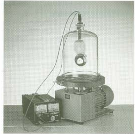
FIG. 12 Een elektrische bel onder een vacuümstolp.
