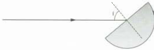
FIG. 8 De lichtstraal treft de half-cilindrische lens in het midden van de rechte zijde.
