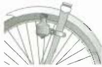
FIG. 9 Overbrenging tussen voorwiel en dynamo.
