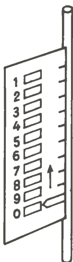
Figuur 16. Vereenvoudigde voorstelling van een stappenschakelaar.
