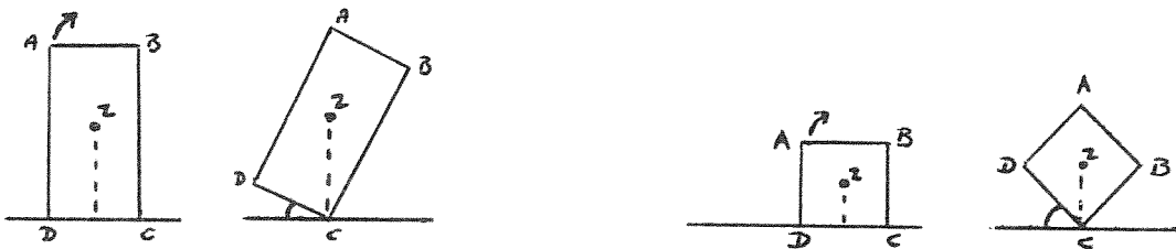
Figuur 8. Invloed van de hoogte van het zwaartepunt op stabiliteit.
