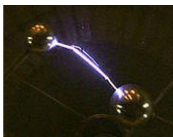
Figuur 1.24: Een vonk springt over tussen twee geladen bollen van een Wimshurst-machine.
