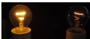
Figuur 1.83: Twee verschillende gloeilampen bij dezelfde (lage) spanning.
