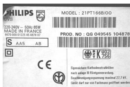
Figuur 1.62: Fabrikantgegevens op de achterkant van een televisie.
