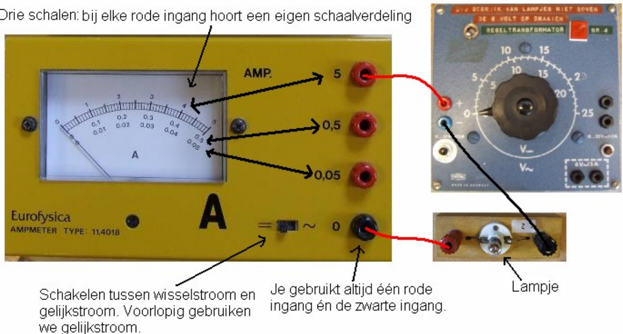
Figuur 1.9: Een ampèremeter aansluiten.
