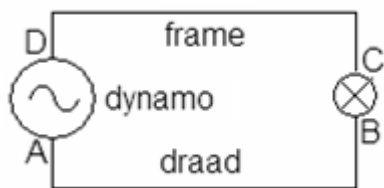
Figuur 1.58: Schakelschema van een fietslampje.
