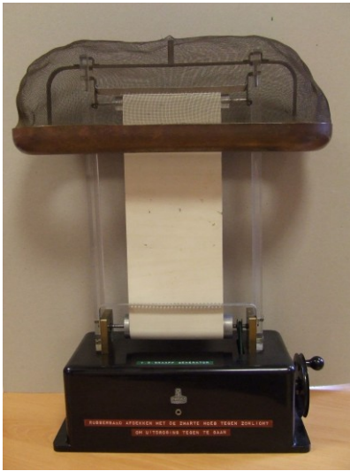
Figuur 1.19: Van der Graaffgenerator.
