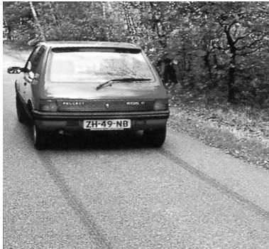
Figuur 25 – Het zichtbare gevolg van schuifwrijving.
