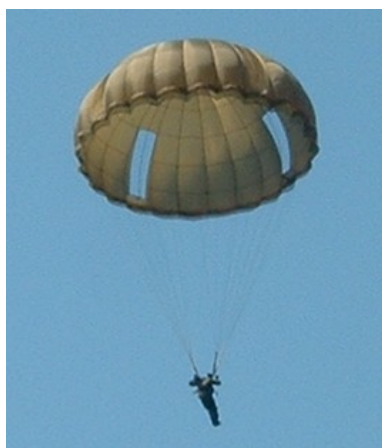
Figuur 30 – De daalsnelheid van de klassiek militaire koepelvormige parachutes ligt rond de 18 \text{ km/h} .
