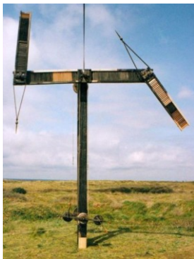
Figuur 1.2 Een Chappe seintoren.
