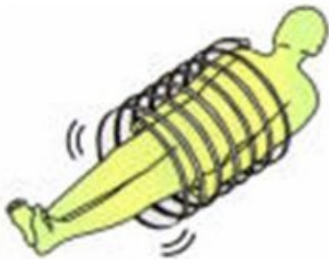
Figuur 5.5 Als de detectoren een schroeflijn om het lichaam trekken, wordt het mogelijk 3D opnamen te maken.
