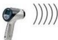
Figuur 4.8 De auto rijdt naar het radarapparaat toe. Daardoor vangt de auto een hogere frequentie op en kaatst die nog eens verhoogd weer terug.
