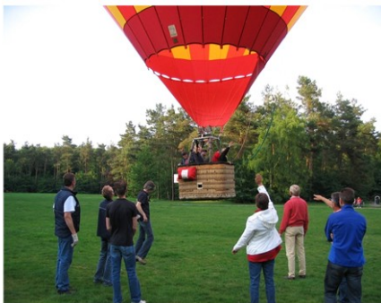
Figuur 22 Verwarmde lucht zet uit en stijgt op. Beter gezegd: Koelere omgevingslucht kruipt onder de ballon en tilt hem op.
