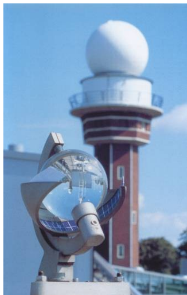
Figuur 4 – De neerslagradar van het KNMI boven op "de kopspijker". Op de voorgrond zie je een zonneshijnmeter waarmee het aantal uren zonneshijnm wordt geregistreerd.
