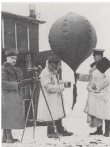
Figuur 60 – Duitse militairen uit de Eerste Wereldoorlog hangen ballast aan een met waterstof gevulde ballon voor ze hem laten opstijgen bij een weerstation aan het westelijk front. Uit de stijgingsrichting, die met behulp van een theodoliet (links) werd bepaald, bleek de snelheid en de richting van de wind.
