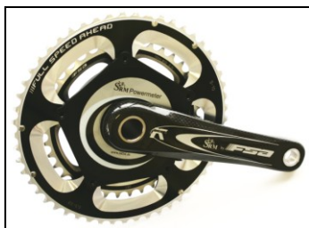
Figuur 74 – Het SRM-systeem zit verborgen in de trapas. Twee sensoren meten de trapkracht en de trapfrequentie.
