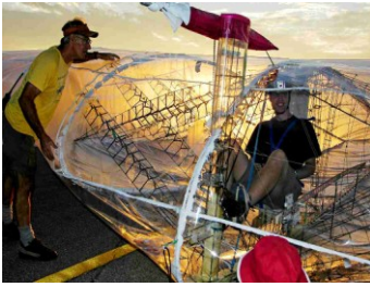
Figuur 81 – De Flycycle. De piloot zit binnen de vleugel.
