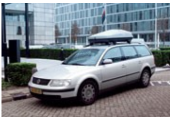
Figuur 61 – De luchtweerstandskracht F_{w,l} hangt ook af van het frontaal oppervlak en de stroomlijn.
