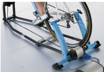
Figuur 68 – Bij een ergometer wordt de tegenwerkende kracht en de fietssnelheid gemeten.
