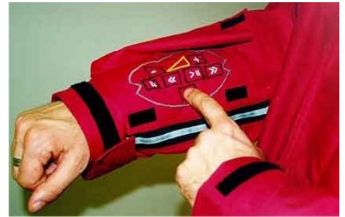
Figuur 3.14 Toepassing van Quantum Tunneling Composiet
