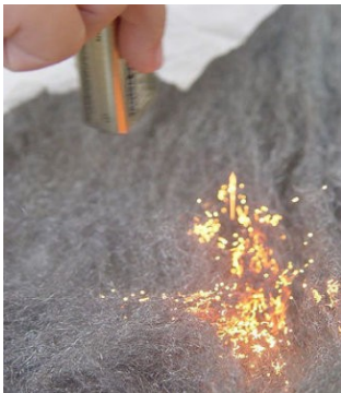
Figuur 1.41 Batterij en staalwol
